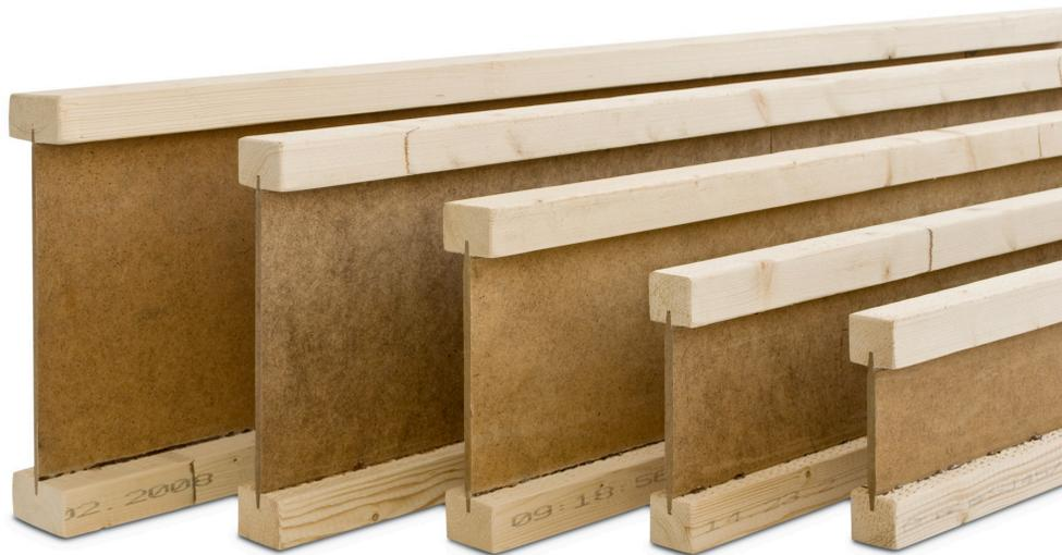
Les poutres STEICO allient légèreté et un rendement énergétique élevé. Elles se composent d'une âme constituée de panneaux de fibre de bois durs reliant deux membrures. Les membrures sont en bois de résineux séché, trié à la machine, et abouté, ou en lamibois LVL R. Ce procédé est garant de qualité et de solidité.
